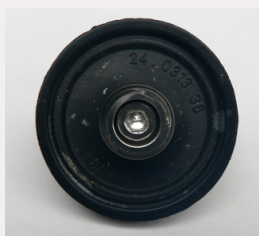
Membrane régulateur de pression
